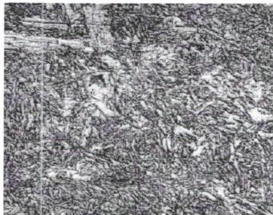
Образец с ОРП (бейнит) \times 125
